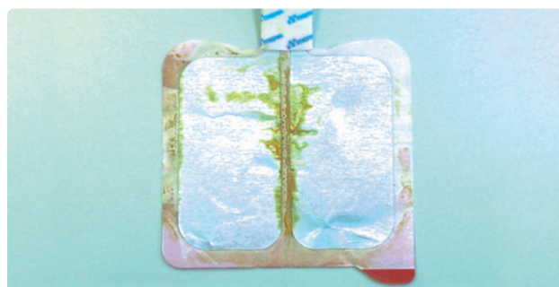
電極部に薬液が侵入した対極板
