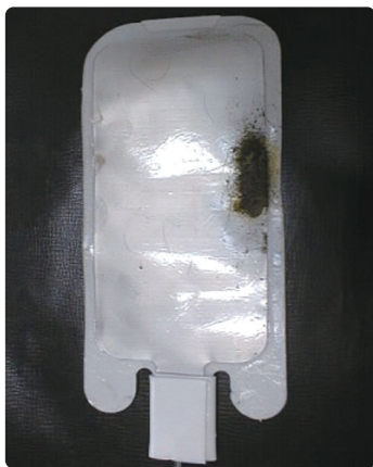
熱傷事故で使用された対極板
